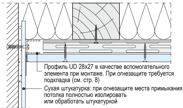
D153-B1 Разрез по продольной кромке
