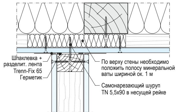
D151-V2 Примыкание перегородки к обшивке потолка
