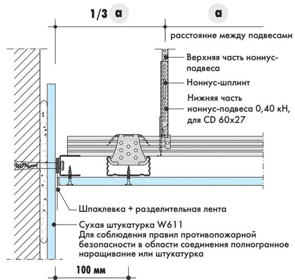
**D112-D3** Соединение со стеной
