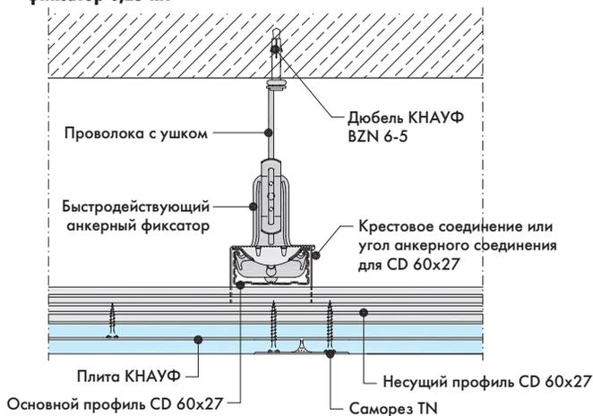
**D112-B4** Стык продольной кромки
