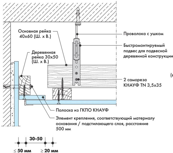
**D111-D8** Соединение со стеной при помощи теневого шва (противопожарная защита)
