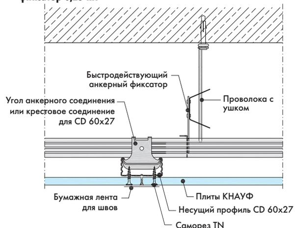
**D112-C4** Стык передней кромки
